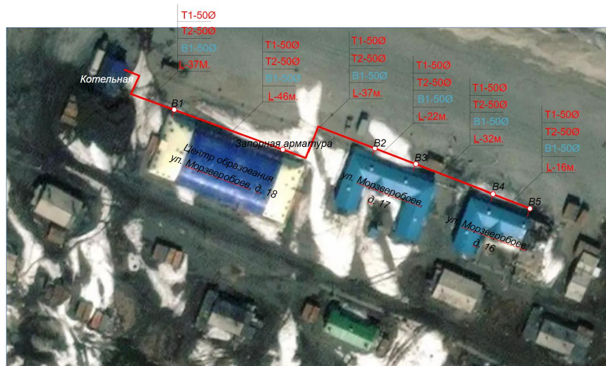
Рисунок 2.1.1.1 – Зона действия существующей системы теплоснабжения
